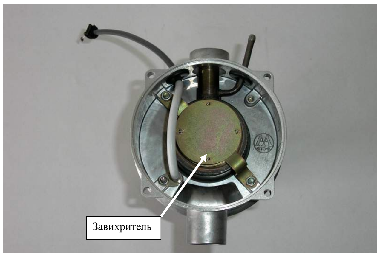
Рис.18- Камера сгорания с переходником и индикатором пламени.
